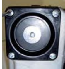
Atornille la tapa del alojamiento del filtro
