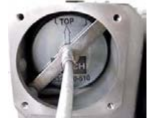
Suelte el tensor con una llave
