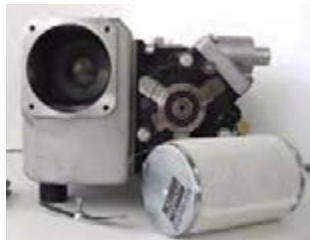
Retire el tensor y el filtro de su alojamiento
